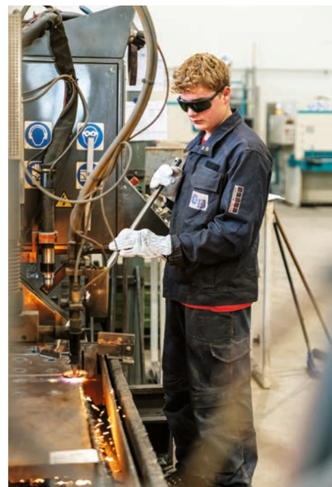
^ L'apprendista metalcostruttore è in grado di svolgere autonomamente molti lavori, come il taglio al pantografo.
